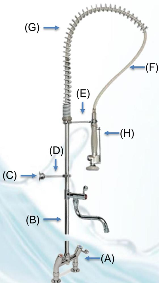
1. Instalar o corpo do misturador (A) na bancada (Distância entre furos 155mm).
